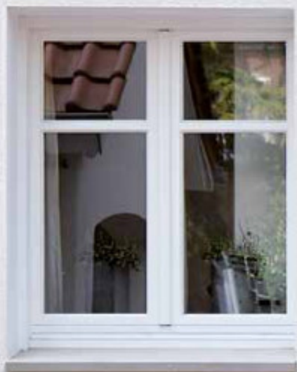
E Express 15 Ansicht A OBERFLÄCHE Verkehrsweiß matt ähnl. RAL 9016 VERGLASUNG Glasausschnitt Klarglas | 0,7 W/m 2 K BESCHLAG Griff Al 11 Edelstahl | PG 0
